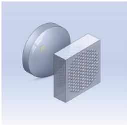
静态投影系统设计示意：微透镜阵列、1个LED光源、1个准直器
