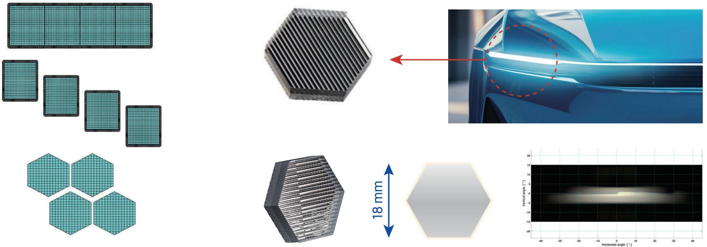
微透镜阵列的多种形状结构示意图
