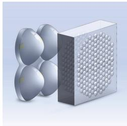
半动态投影系统设计示意：微透镜阵列（带4个子图案）、4个LED光源、4个准直器
