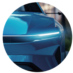
超薄大灯设计 (透镜大小 < 15mm, 甚至可达 < 10mm)
