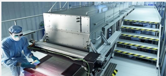
固体激光剥离紫外激光线光斑系统
