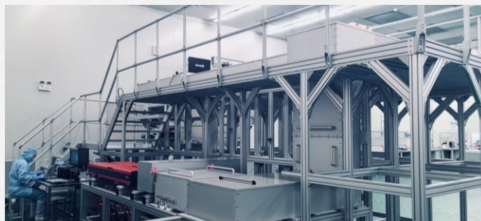
固体激光退火紫外激光线光斑系统
