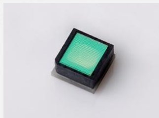
基于微透镜阵列的 点阵投影光源
