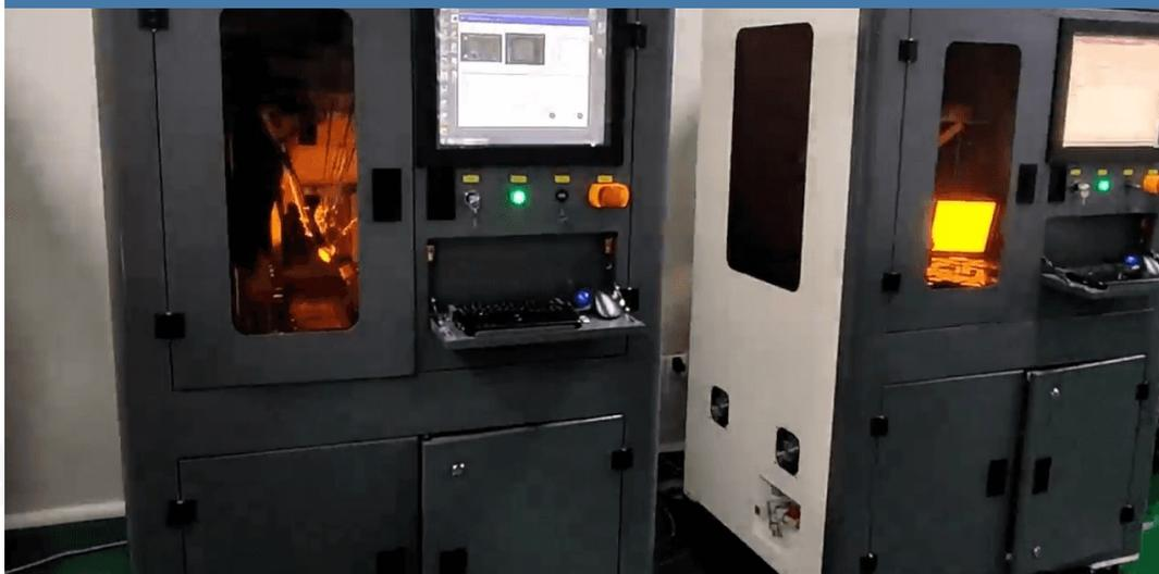
激光雷达发射端模组生产产线
