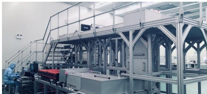
固体激光退火紫外激光线光斑系统
