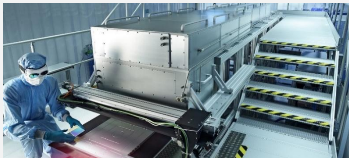
固体激光剥离紫外激光线光斑系统
