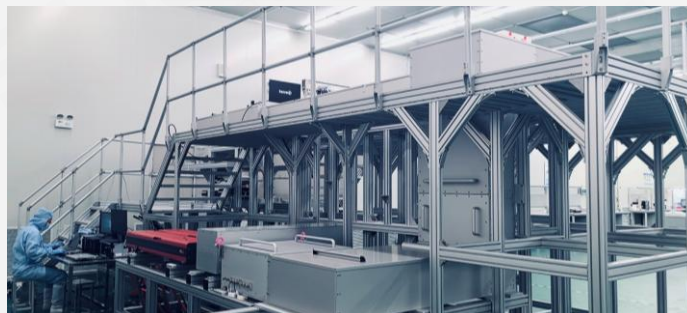
固体激光退火紫外激光线光斑系统
