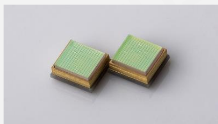
车规级 VCSEL 面光源发射模组, 适用于 DMS (驾驶员监控系统)
